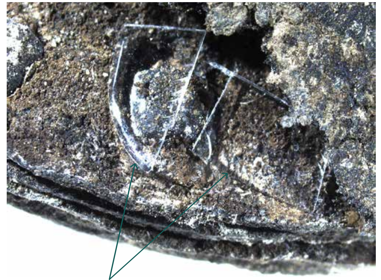
Abb. 17: Mikroskopfoto: Acrylatfolie, die zwischen gespaltene Lederschichten geschoben wurde, ÄS 3259, Bildbreite: ca. 12 mm, © Foto: Ina Schneebauer-Meißner.
