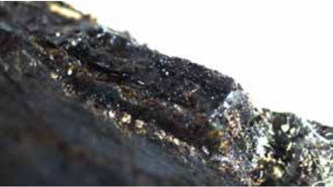
Abb. 16: Mikroskopfoto: Bruchkante von stark gelatinisiertem Leder, ÄS 3209 Bildbreite: ca. 7 mm, © Foto: Ina Schnee-bauer-Meißner.
