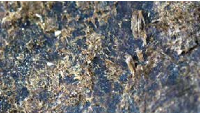
Abb. 15: Mikroskopfoto: faserige Struktur des Leders noch partiell vor-handen, ÄS 3209, Bildbreite: 9 mm, © Foto: Ina Schnee-bauer-Meißner.
