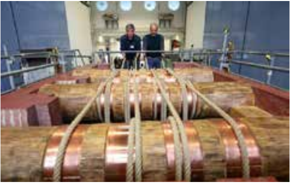
Abb. 18: Nachbau der Fallsteinkammer der Cheops-Pyra-mide und Herablassen der Blockiersteine mittels Seil-führung nach Dorka, Universität Kassel, © Foto: Andreas Fischer.
