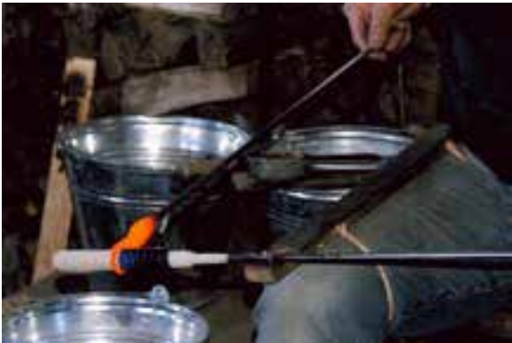
Abb. 7: Spiralförmiges Aufwickeln der Basisschicht um den Kern, aus: CESARIN 2019, Fig. 23.
