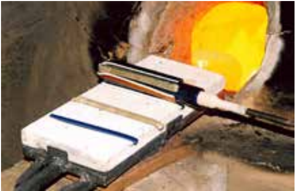
Abb. 9: Auftragen der Glasbänder auf die Basisschicht, aus: CESARIN 2019, Fig. 25.
