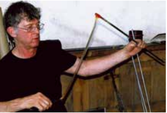
Abb. 4: Auseinanderziehen der Glasbänder, aus: CESARIN 2019, Fig. 20.
