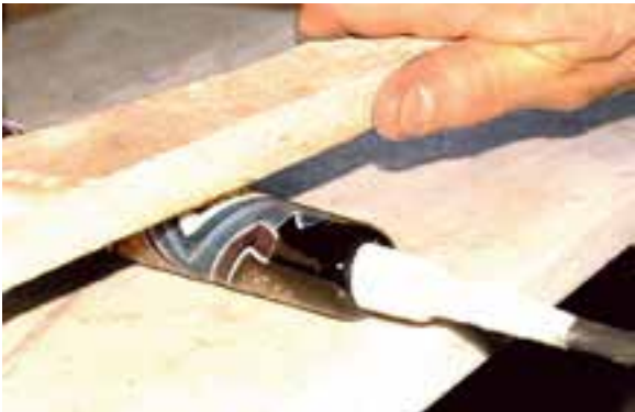
Abb. 8: Glätten des Gefäßes auf einer Steinplatte (= Marbeln), hier zusätzlich unter Zuhilfenahme einer weiteren Steinplatte, aus: CESARIN 2019, Fig. 29.
